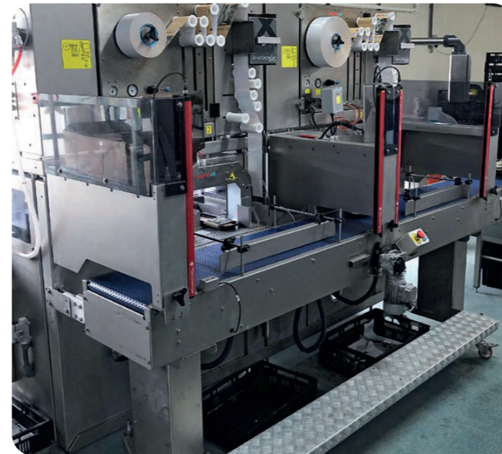
Die Bandall TRCS-Maschine bei Klooster hat zwei Köpfe und kann maximal 40 Verpackungen pro Minute verarbeiten.
